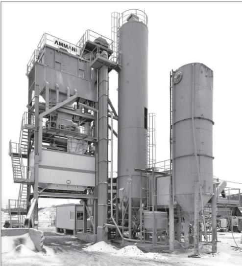
● АБЗ «AMMANN» производит в час 120 тонн качественного асфальтобетона.
